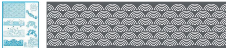
80mm孔洞间隔规律排布（该方案视觉效果较为有韵律感，灯位均匀布置，加工、施工难度小，可使用标准灯具。）
