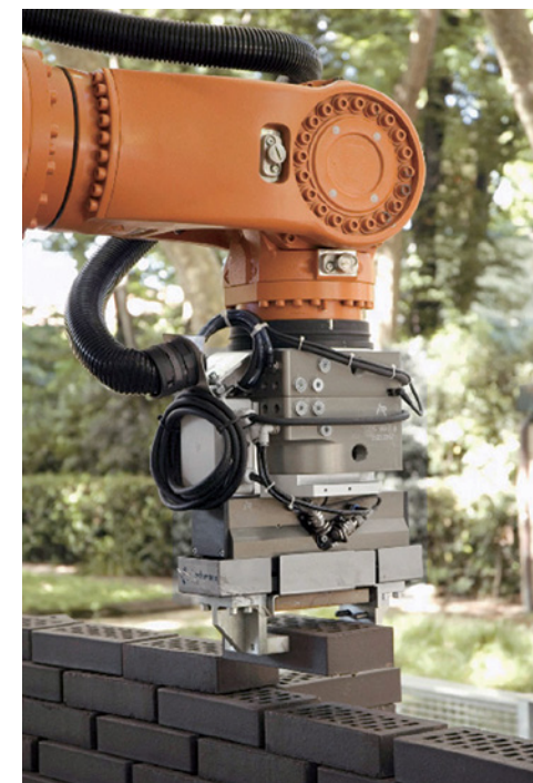
机械手驱动砖块堆叠过程
