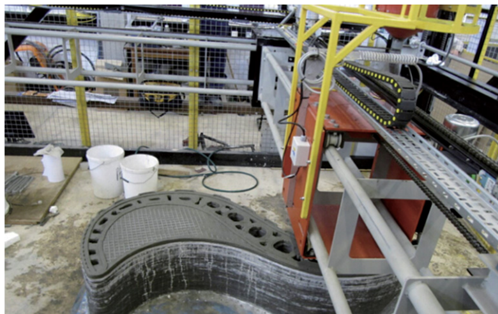
混凝土打印工艺制作的构件
