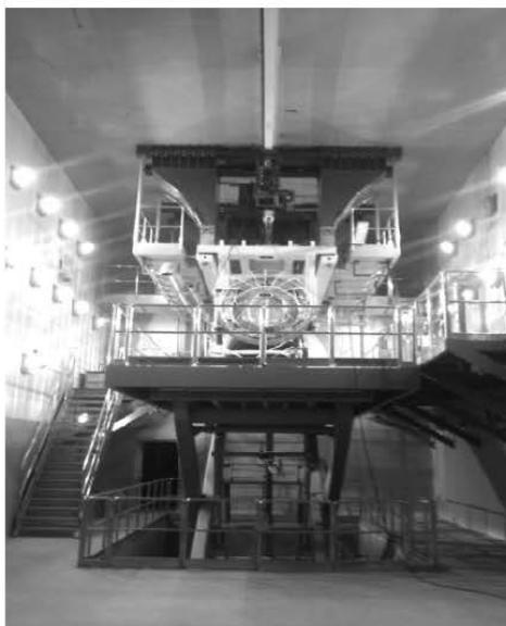
图1 航空发动机试车台
